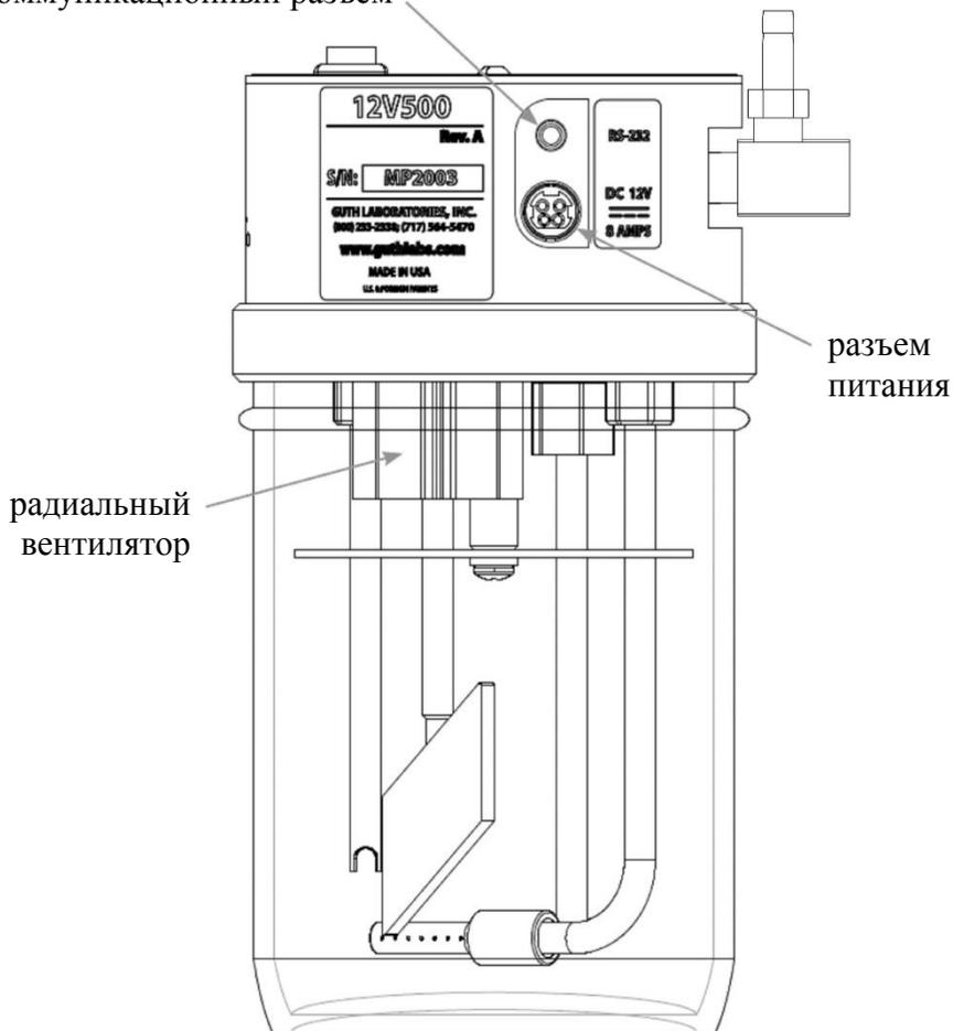
Рисунок 2 – Внешний вид генератора (вид сзади)
