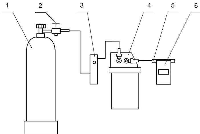
1 – баллон с воздухом (азотом); 2 – вентиль; 3 – ротаметр; 4 – генератор;
