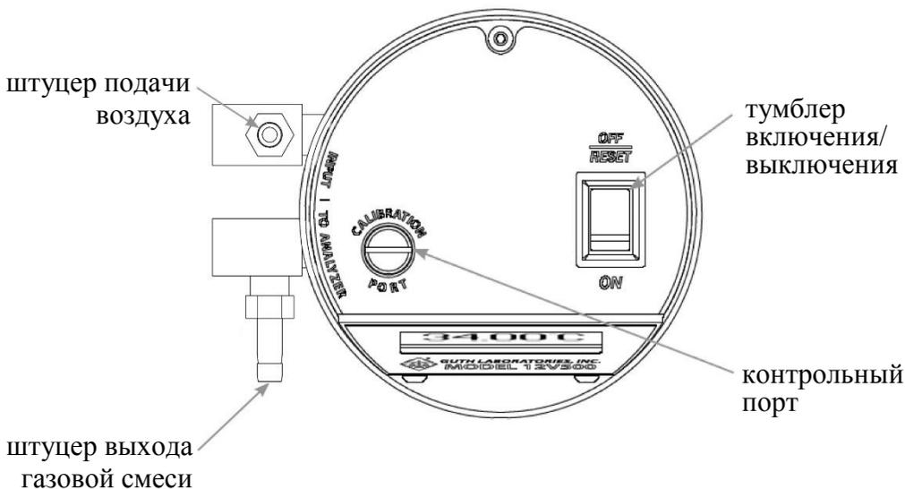
Рисунок 3 – Внешний вид генератора (вид сверху)
